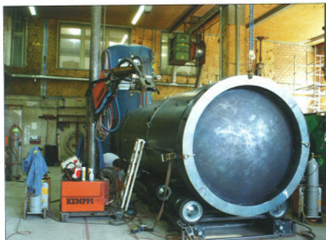
Construction d'un accumulateur de 30 000 litres.
