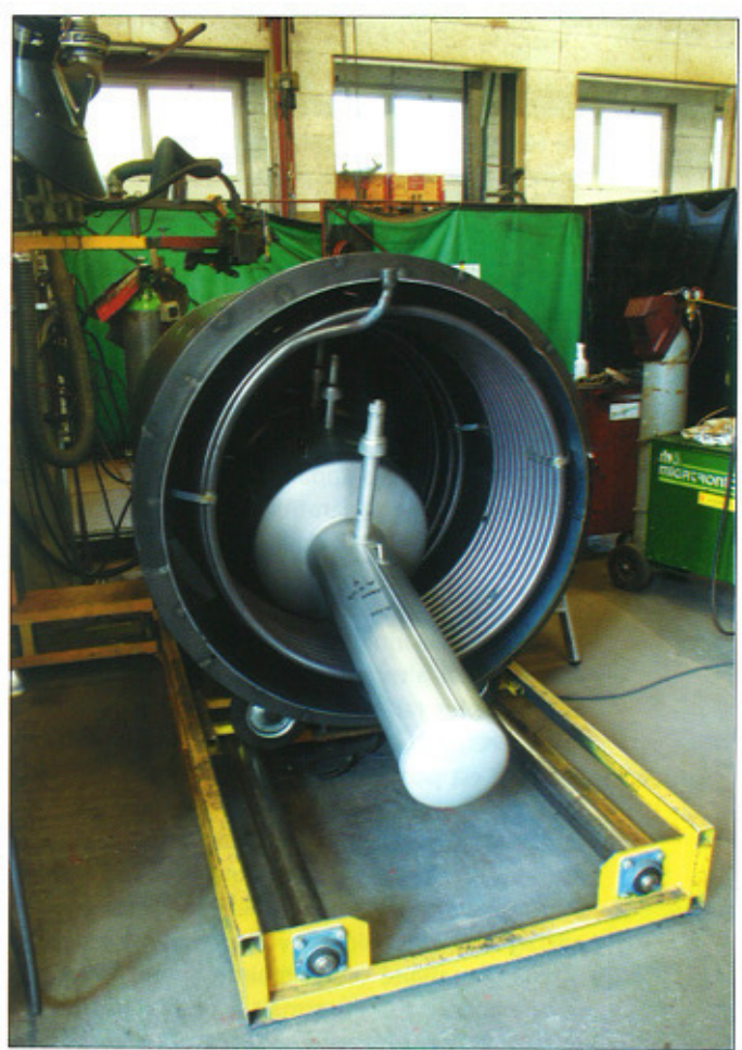
Accumulateur en cours d'assemblage, avec l'échangeur thermique à tubes lisses soudé à l'intérieur, et le chauffe-eau intégré en acier chrome nickel molybdène.
