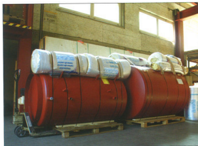
Accumulateurs prêts à être livrés, après avoir été testés à une pression de 4,5 bars (la pression courante de fonctionnement s'élève à 3 bars).
