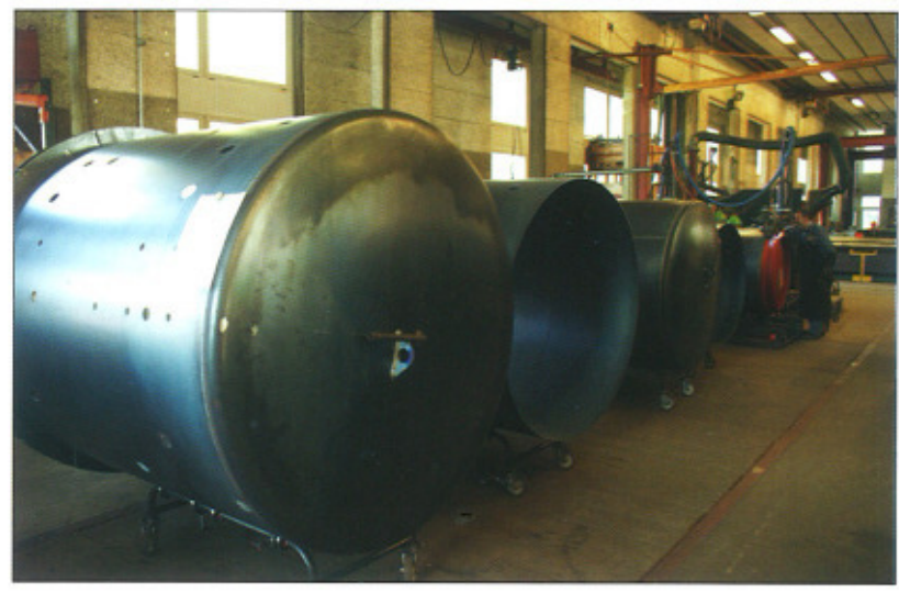
Accumulateurs de 3/4000 litres en cours de fabrication.
