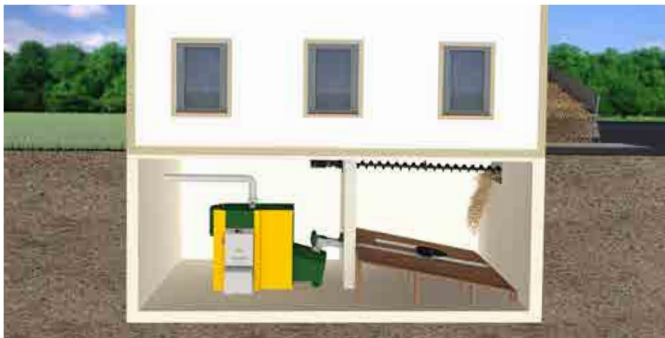
KWB Multifire mit Rührwerk und Förderschnecke: Lagerraumbefüllung mittels Befüllschnecke
