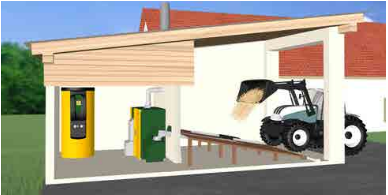
KWB Multifire mit Rührwerk und Förderschnecke: direkte Lagerraumbefüllung
