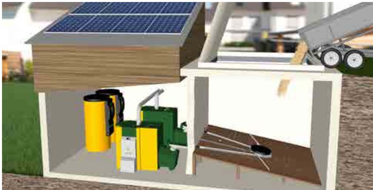
KWB Multifire Doppelanlage mit Rührwerk und 2 Förderschnecken: direkte Lagerraumbefüllung
