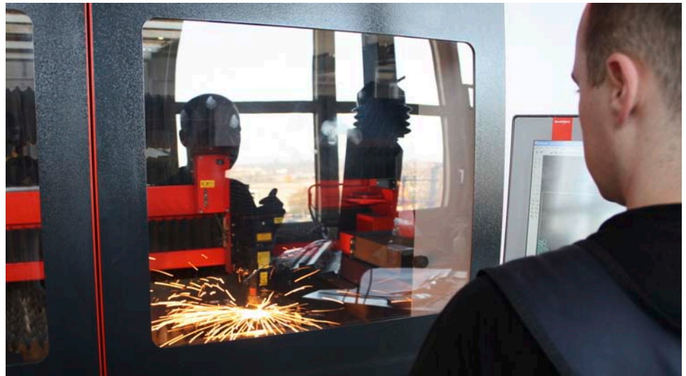
Laserschneidmaschinen dienen bei der Lasatec AG zur Produktion anspruchsvoller Formgebungen, erzeugen aber auch viel Abwärme. (Bild: Lasatec)
